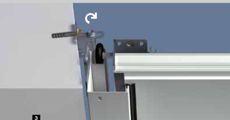
4 Montaggio su facciate non portanti (klinker o coibentazione termica) con min. 90 mm o max. 125 mm di battuta laterale
