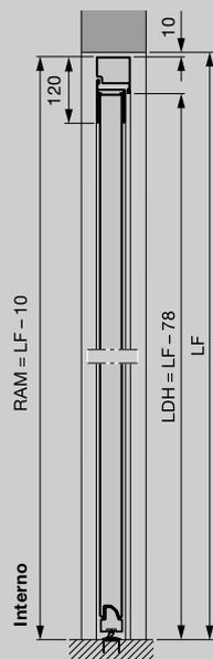
Porta pedonale laterale con telaio tubolare in alluminio, profilo tipo 2
