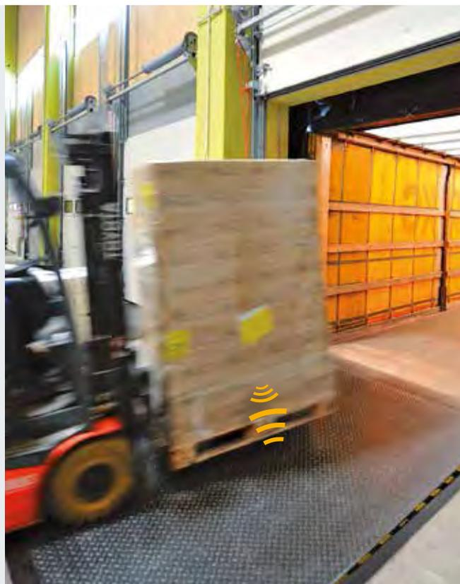
Rilevamento automatico dei movimenti delle merci semplicemente al passaggio sulla pedana di carico.
